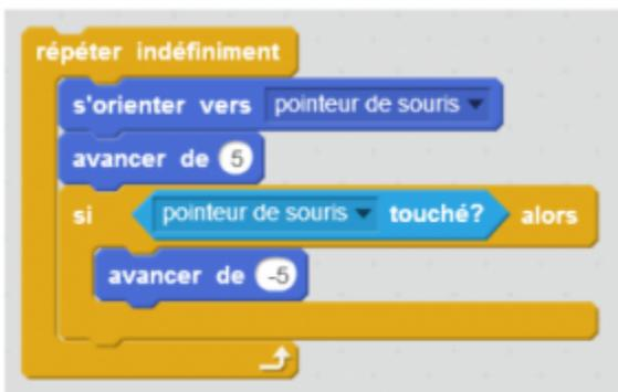
Explication du code : le lutin va d'abord se tourner vers le pointeur de la souris, puis avancer de 5 pas. S'il a touché le pointeur, il va avancer de « -5 » pas, c'est-à-dire reculer.
