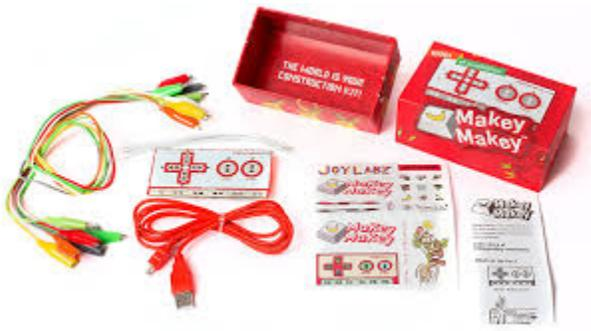
Makey Makey est un petit dispositif composé d'un circuit imprimé pré-programmé, de pinces crocodiles et d'un branchement USB. Une fois branché à votre ordinateur Makey Makey fonctionnera comme un second clavier et tout objet branché sur le Makey Makey fonctionnera comme une touche du clavier. Mais pour cela les objets doivent être conducteurs d'électricité : pâte à modeler, fruits, eau, plantes, papier d'aluminium, encre conductrice, graphite... un vaste choix s'offre à vous.
