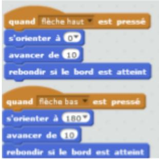
Quand on appuie sur la flèche du haut, le lutin s'oriente vers le haut (à 0) et avance de 10. Si le bord est atteint, le lutin rebondit, c'est-à-dire qu'il est repoussé pour ne pas sortir de l'écran.
